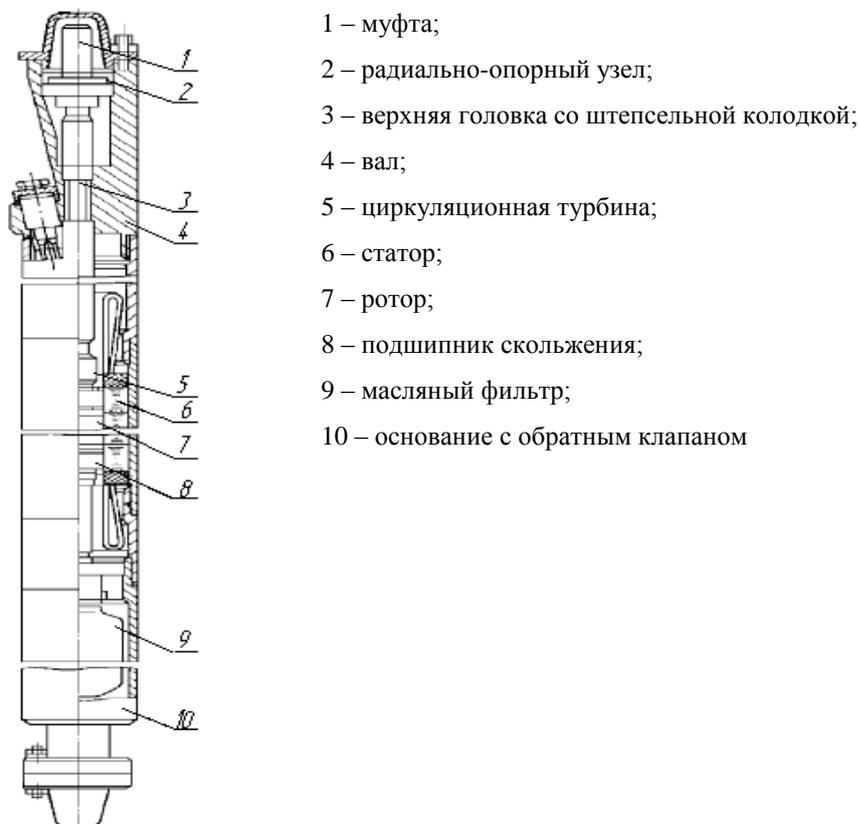
Рис. 2. Электродвигатель серии ПЭД
