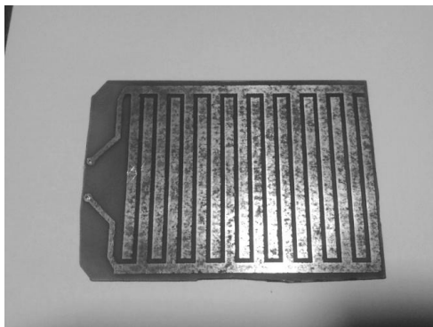
Рис. 1. Рабочий элемент емкостного датчика влажности
