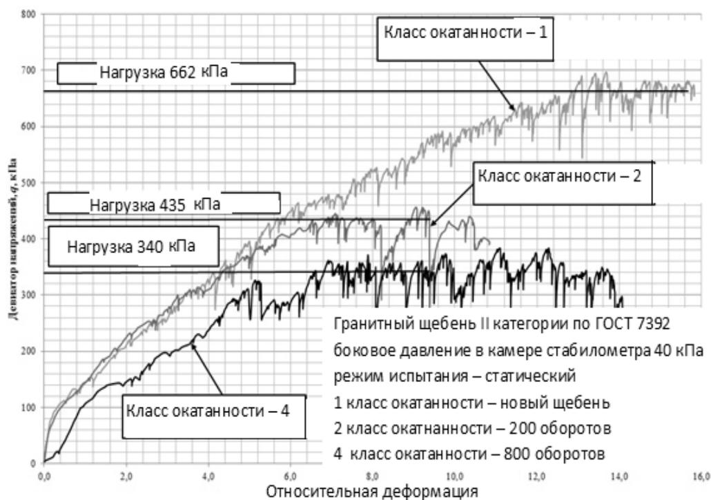
Рис. 3. Кривые разрушения образцов щебня в камере трехосного нагружения при разной степени обработки образцов балласта в полочном барабане (боковое давление в камере стабилометра 40 кПа)
