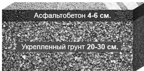
Рис. 2. Разрез дорожного основания при методе стабилизации грунта
