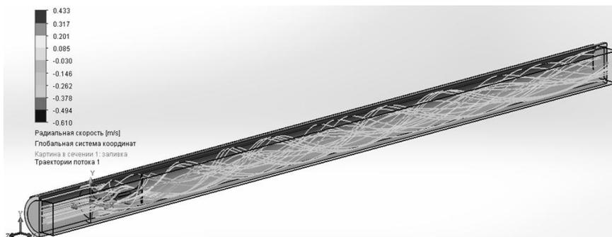
Рис. 7. Траектории движения потока жидкости с изменением давления
