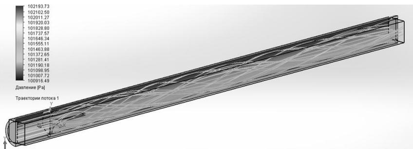
Рис. 2. Траектории движения потока жидкости с изменением давления
