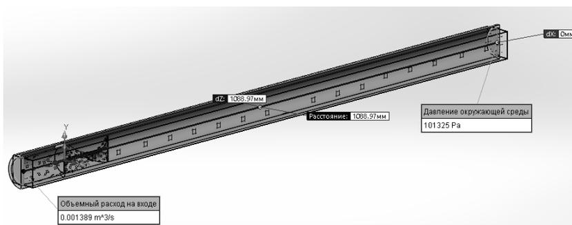
Рис. 6. Опытный образец № 2 с длиной трубопровода 1000 мм и диаметром трубы 57 мм (внутренний диаметр 45 мм)
