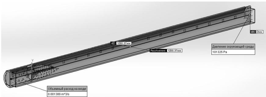
Рис. 1. Опытный образец № 1 с длиной трубопровода 1000 мм и диаметром трубы 57 мм (внутренний диаметр 45 мм)
