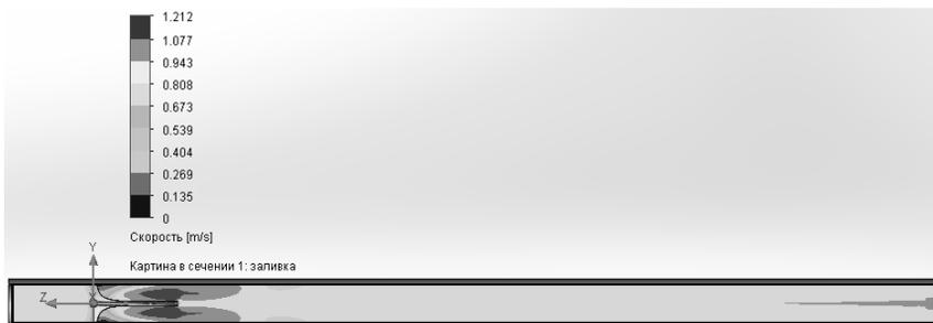
Рис. 5. Картина распределения скорости в сечении трубопровода
