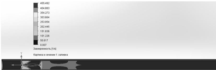
Рис. 9. Картина распределения завихренности в сечении трубопровода
