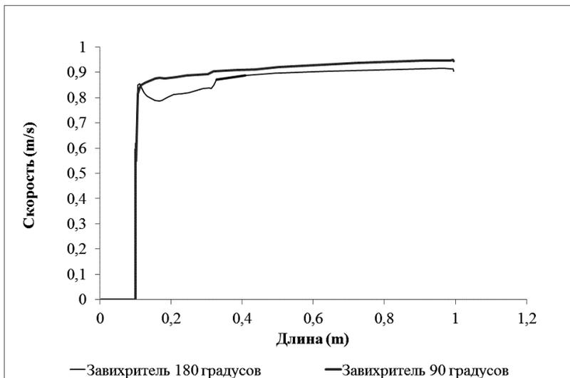
Рис. 12. График зависимости скорости от длины трубопровода
