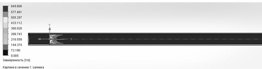
Рис. 4. Картина распределения завихренности в сечении трубопровода
