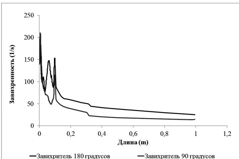
Рис. 13. График зависимости завихренности потока от длины трубопровода
